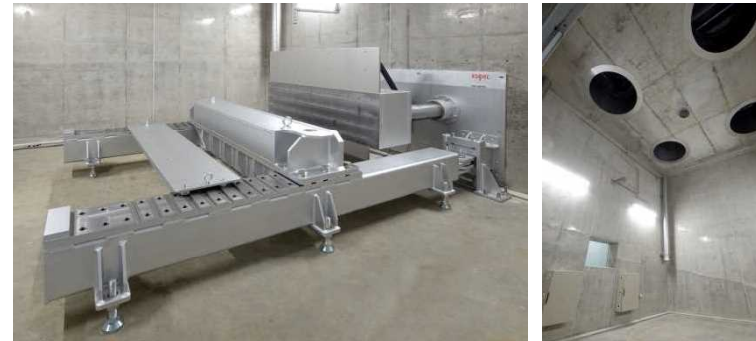
圧壊試験機(第1安全試験室) 第2安全試験室
