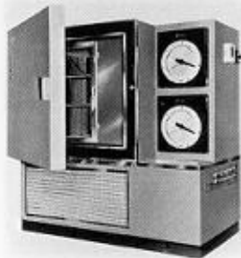
【 Low temperature & humidity chamber "Lucifer" 】
