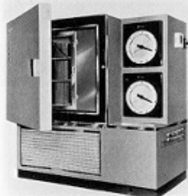
【 Low temperature & humidity chamber "Lucifer" 】
