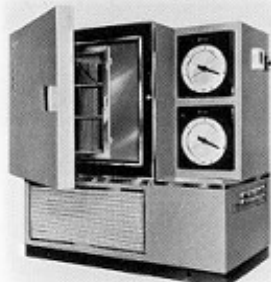
【 Low temperature & humidity chamber "Lucifer" 】
