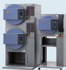
Air-HAST機能付 高度加速寿命評価装置
