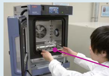
小型環境試験器を用いて ゴムの硫化影響度評価試験を実施
