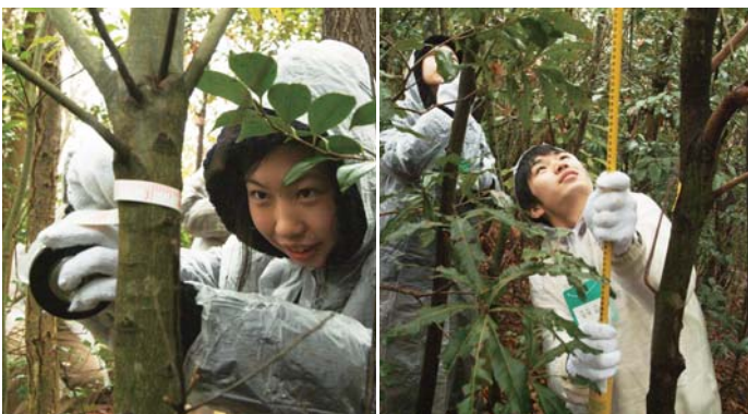
樹木のCO 2 固定量の推定実習 樹木の直径と高さを計測して算出します
