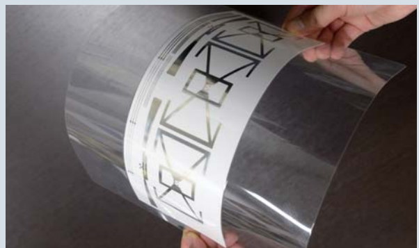
PEを用いた電子デバイス/柔らかい素材にも電子回路が作れます
