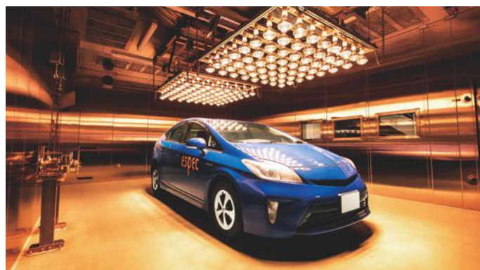
自動車が一台入る実車試験装置
