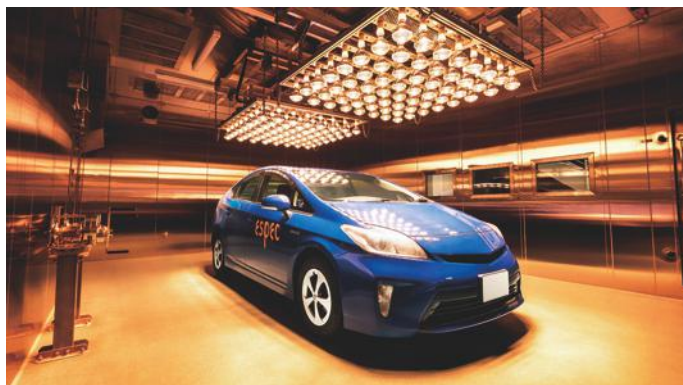
可整车驶入的试验设备
