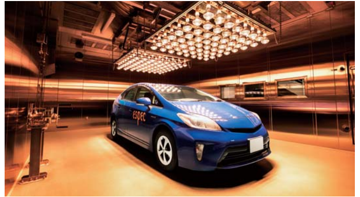
自動車が一台入る車両環境試験室
