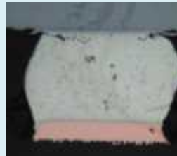
微小龟裂发生
