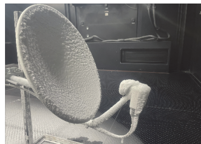
アンテナへの自然環境模擬着雪状態（着雪が氷結し除去不能）
