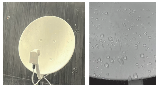
降雨試験におけるアンテナへの水膜付着事例
