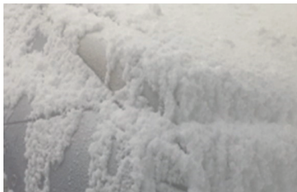
車両への人工着雪状態（着雪は雪や手で簡単に除去可能）
