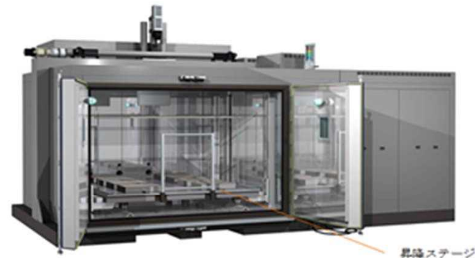
【釘刺し・圧壊試験機】 セルからパック電池まで対応
