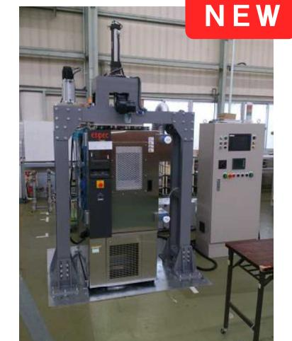
二次電池評価用装置 二次電池安全性試験装置
