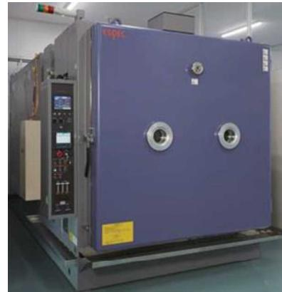
圧力をコントロールする恒圧恒温器
