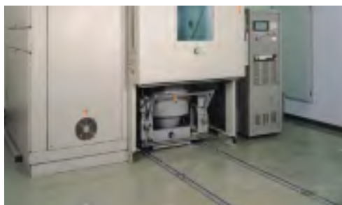
振動発生機レール移動方式
