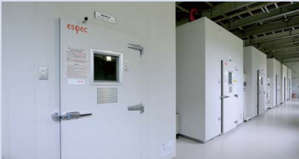
亜熱帯砂漠と冷涼帯砂漠を再現できる乾燥地環境再現実験設備
