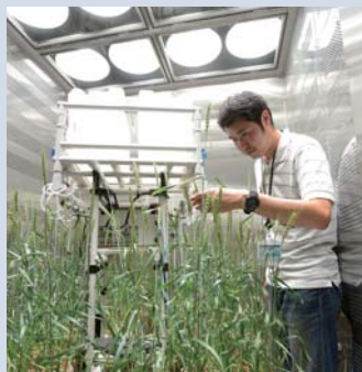
乾燥地植物気候変動応答実験設備 (内部) 小麦の乾燥ストレスを実験
